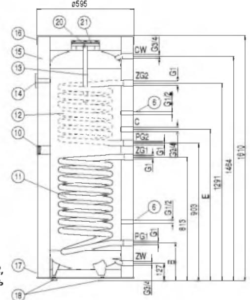
**Верхний змеевик (патрубки ZG2, PG2) и верхняя гильза датчика есть только в моделях SB и SBZ.**
