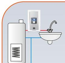
Возможность подогрева предварительно нагретой воды. Температура воды на входе до 70°C.
